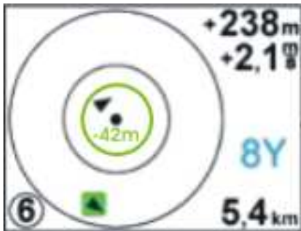
Darstellung eines sich nähernden Luftfahrzeuges (noch ungefährlich) ohne Positionsabstrahlung (Entfernung ca. 2km, 42m unter eigener Flughöhe)
